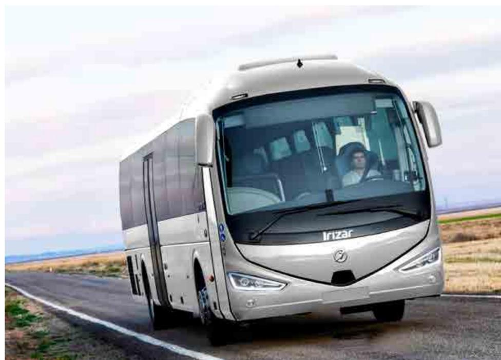
En option, un radar est intégré dans la partie centrale avant comme mesure de sécurité. Les phares avant Irizar avec l'option Full-LED offrent jusqu'à 30 % de capacité lumineuse en plus. Le reste des éléments d'éclairage sont également à technologie LED.
